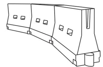
**LONGITUDINAL CHANNELIZING DEVICES (LCD)**
