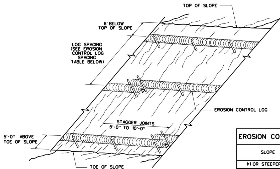
**EROSION CONTROL LOGS ON SLOPES
