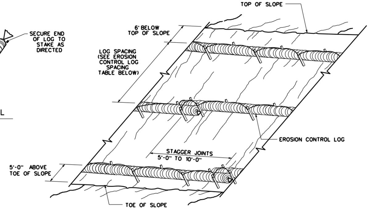
**EROSION CONTROL LOGS ON SLOPES
