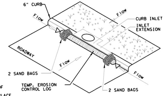
**EROSION CONTROL LOG AT CURB INLET**
