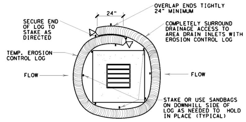
**EROSION CONTROL LOG AT DROP INLET**
