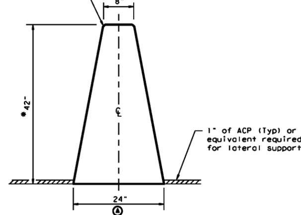
**SINGLE SLOPE CONCRETE BARRIER**
