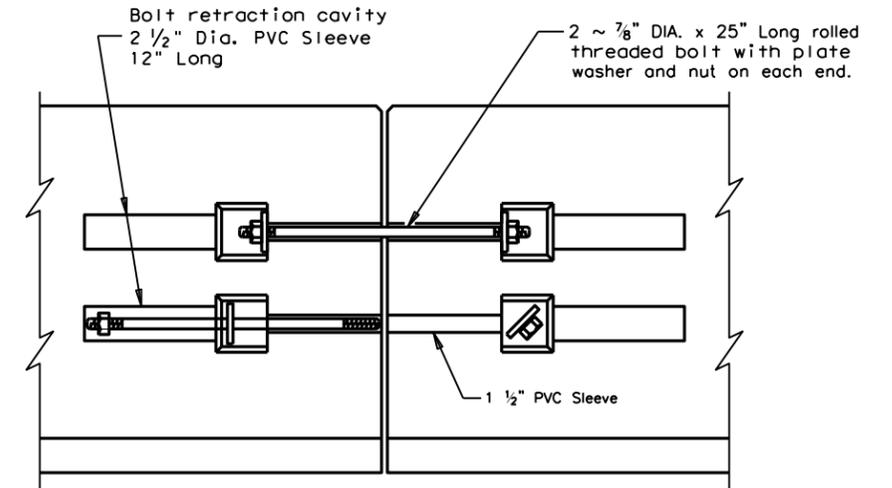
**ELEVATION VIEW SHOWING JOINT CONNECTION**
