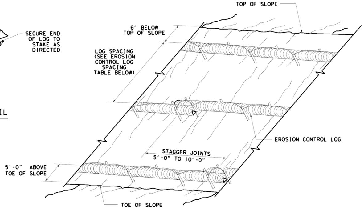
**EROSION CONTROL LOGS ON SLOPES
