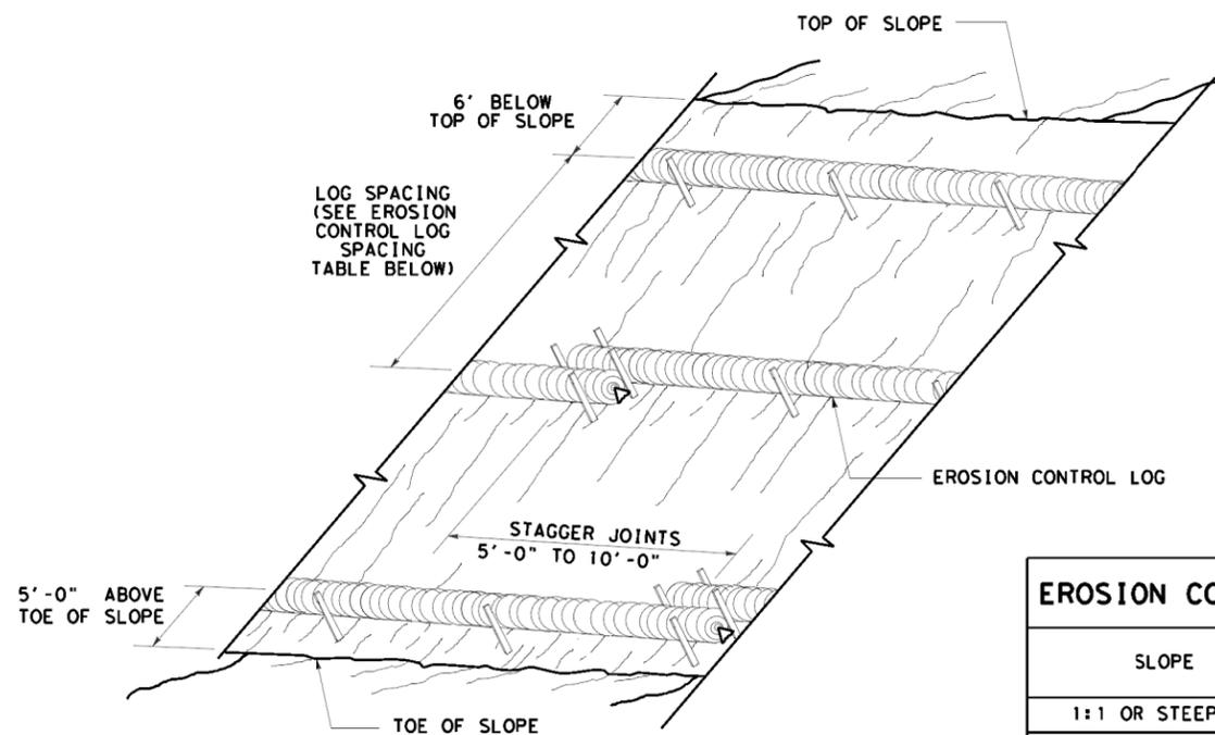
**EROSION CONTROL LOGS ON SLOPES
