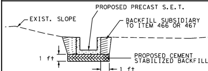
**PRECAST END TREATMENT BACKFILL DETAIL**
