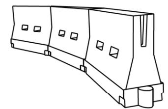
**LONGITUDINAL CHANNELIZING DEVICES (LCD)**
