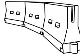
**LONGITUDINAL CHANNELIZING DEVICES (LCD)**
