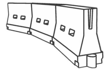
**LONGITUDINAL CHANNELIZING DEVICES (LCD)**
