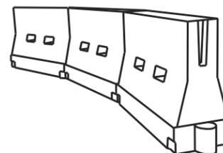
**LONGITUDINAL CHANNELIZING DEVICES (LCD)**
