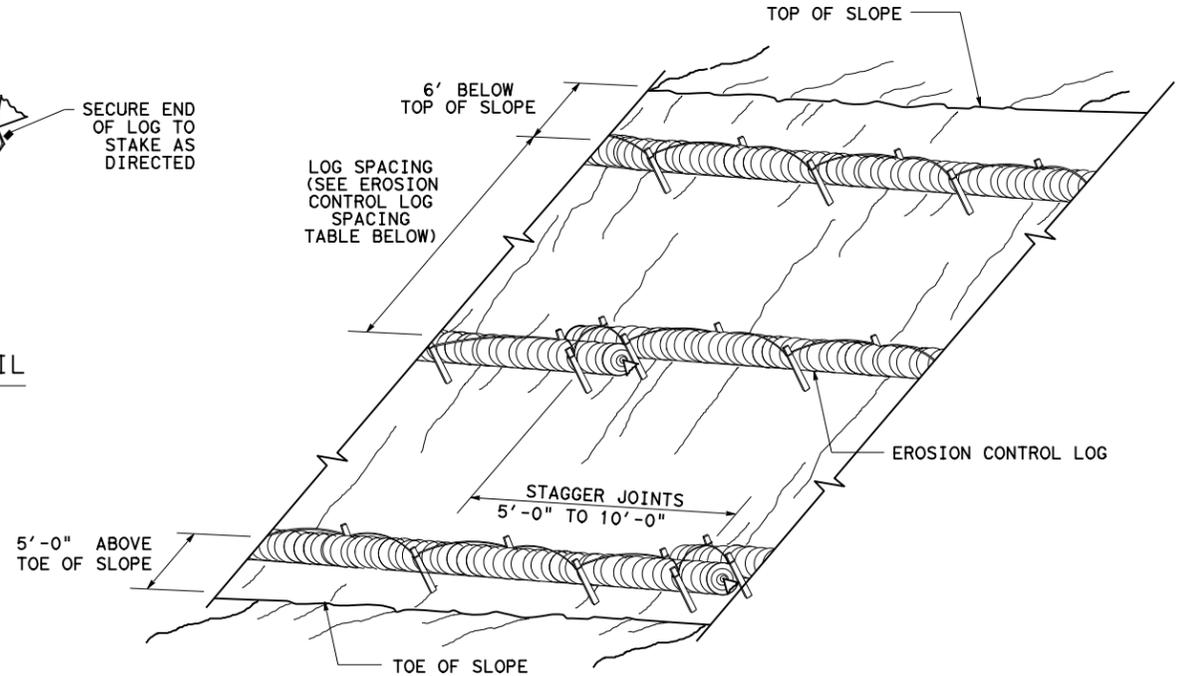
**EROSION CONTROL LOGS ON SLOPES
