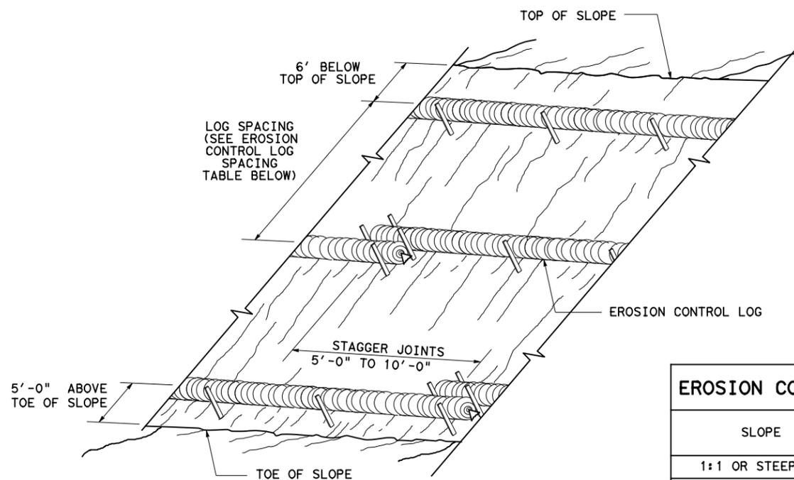
**EROSION CONTROL LOGS ON SLOPES
