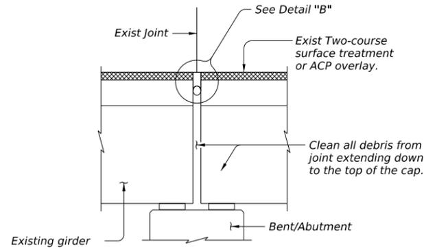
**JOINT W/ HOT-POURED RUBBER SEAL**
