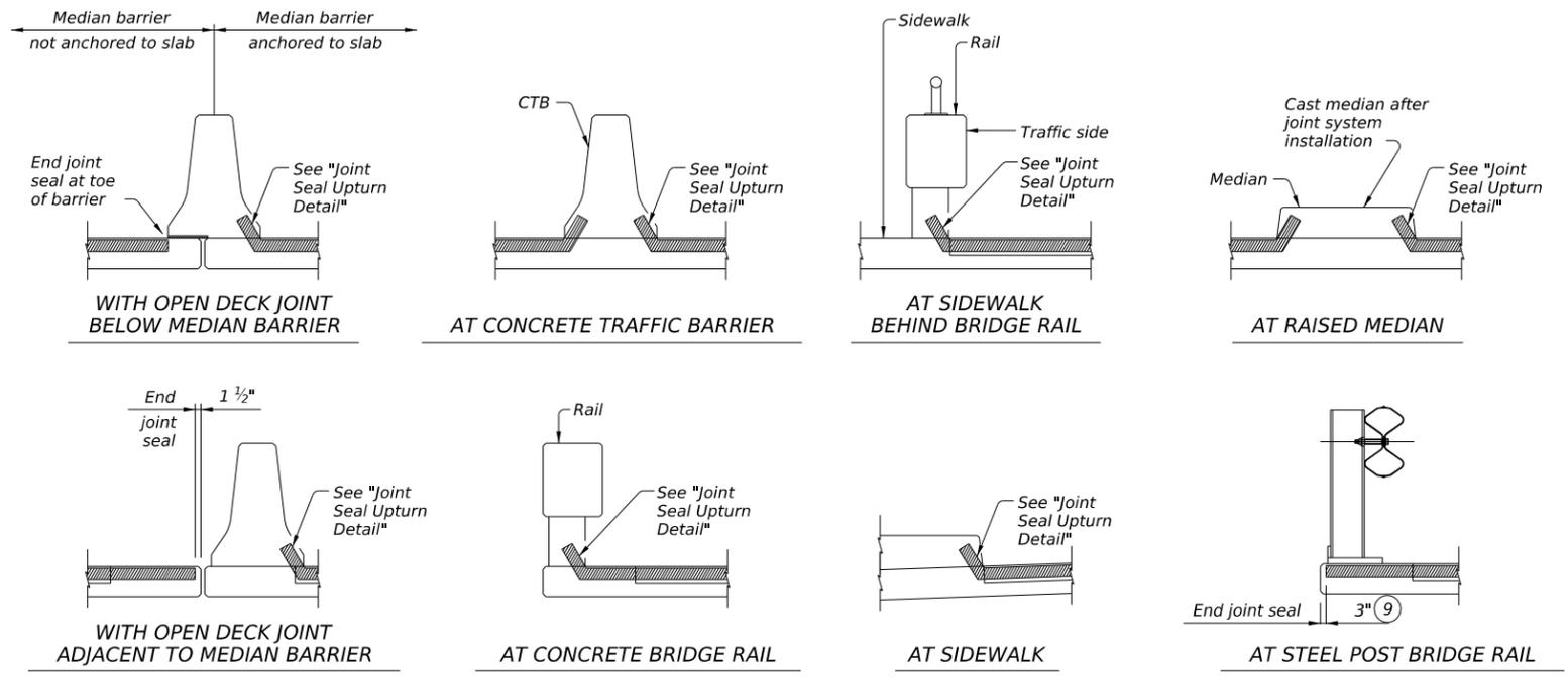
**JOINT SEALANT TERMINATION DETAILS**
