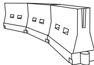
**LONGITUDINAL CHANNELIZING DEVICES (LCD)**
