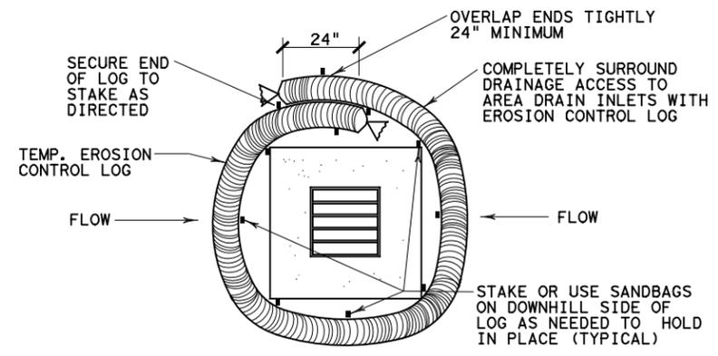
**EROSION CONTROL LOG AT DROP INLET**
