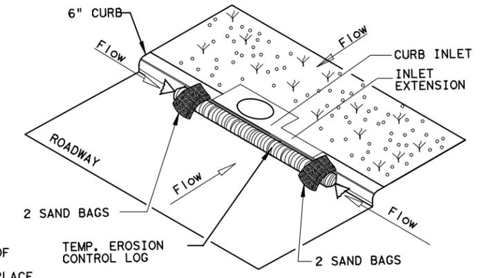
**EROSION CONTROL LOG AT CURB INLET**
