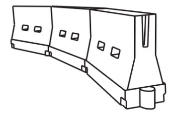
**LONGITUDINAL CHANNELIZING DEVICES (LCD)**
