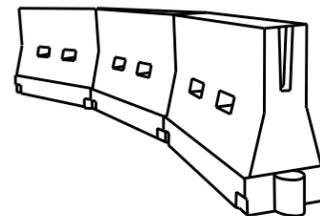
**LONGITUDINAL CHANNELIZING DEVICES (LCD)**
