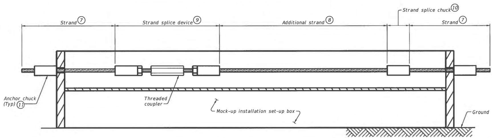
**SETUP OF MOCK-UP INSTALLATION FOR STRAND SPLICING**
