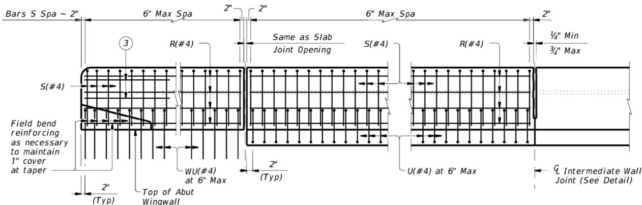
**ELEVATION SHOWING TYPICAL REINFORCING PLACEMENT**
