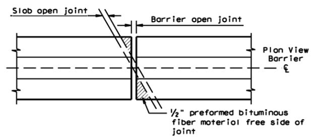
**BARRIER OVER TRANSVERSE OPEN JOINT**
