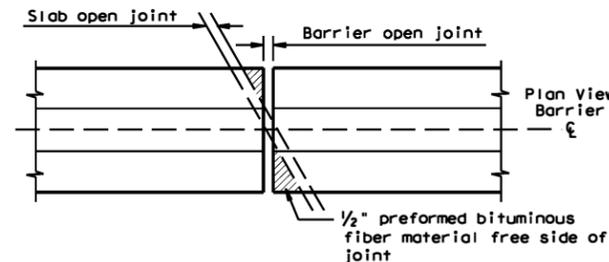
**BARRIER OVER TRANSVERSE OPEN JOINT**
