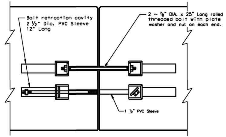
**ELEVATION VIEW SHOWING JOINT CONNECTION**
