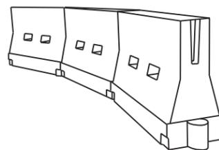
**LONGITUDINAL CHANNELIZING DEVICES (LCD)**
