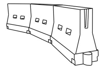
**LONGITUDINAL CHANNELIZING DEVICES (LCD)**
