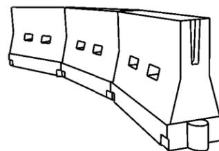
**LONGITUDINAL CHANNELIZING DEVICES (LCD)**
