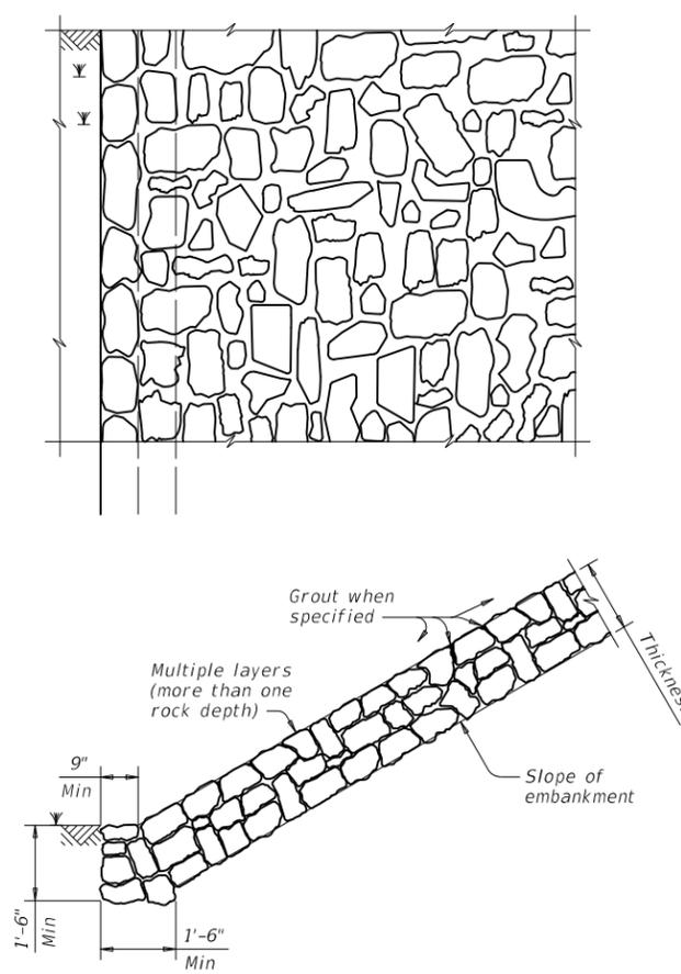
**FIGURE 4 ~ COMMON STONE RIPRAP**
