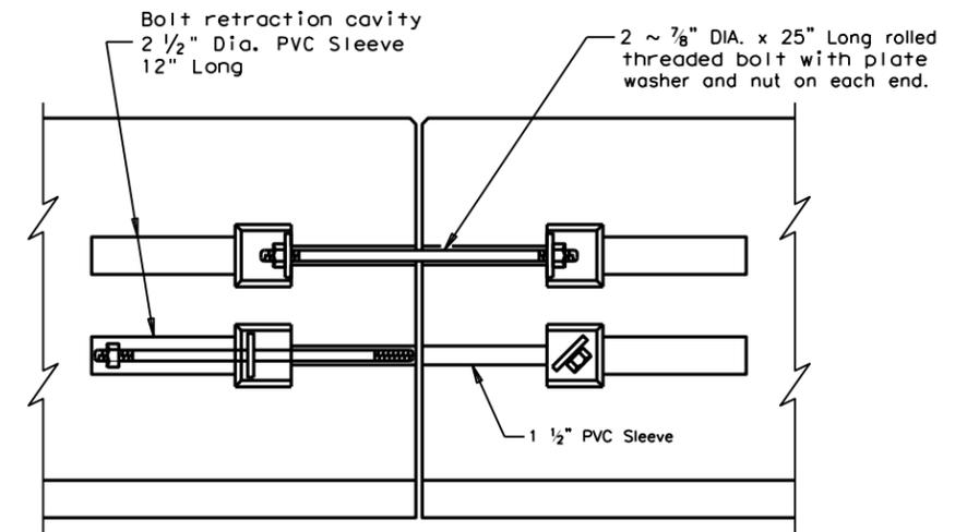
**ELEVATION VIEW SHOWING JOINT CONNECTION**
