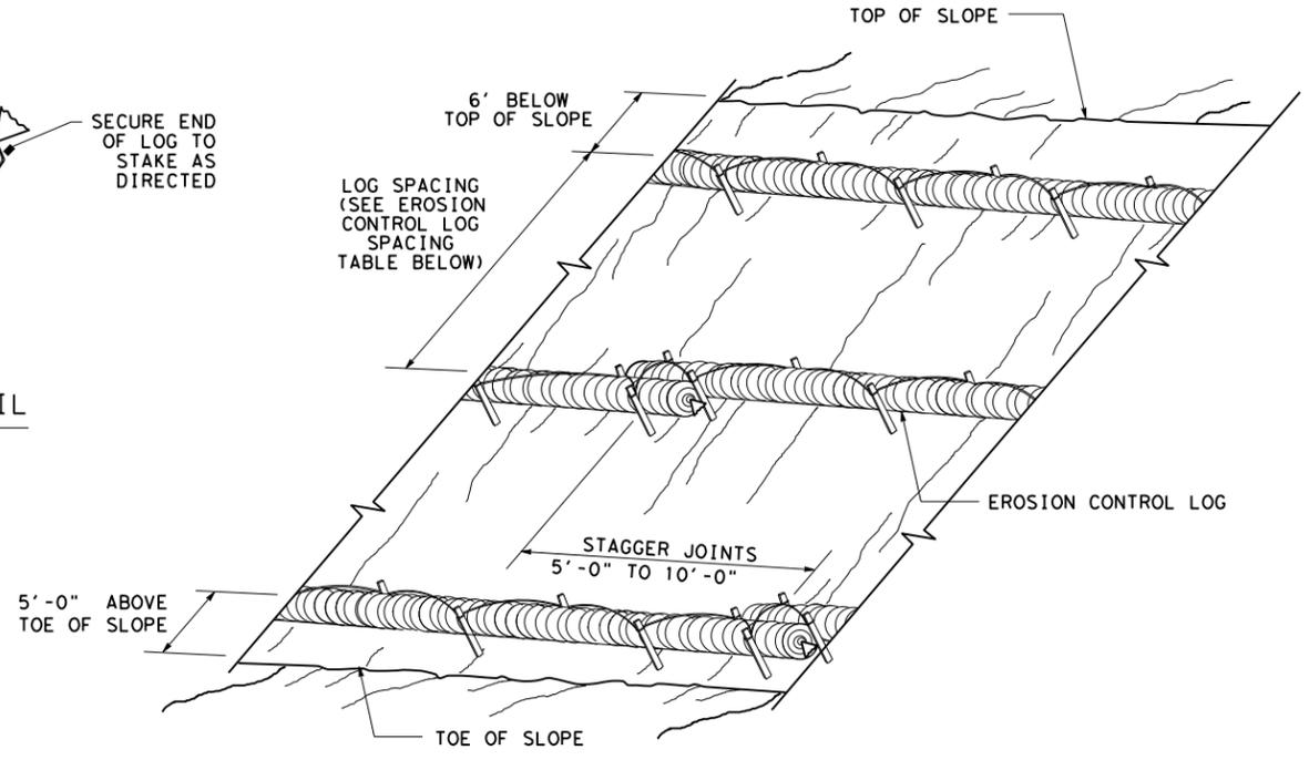
**EROSION CONTROL LOGS ON SLOPES
