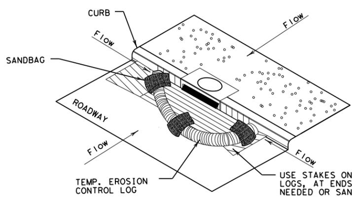
**EROSION CONTROL LOG AT CURB INLET**
