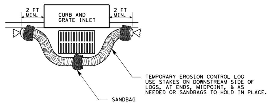
**EROSION CONTROL LOG AT CURB & GRADE INLET**
