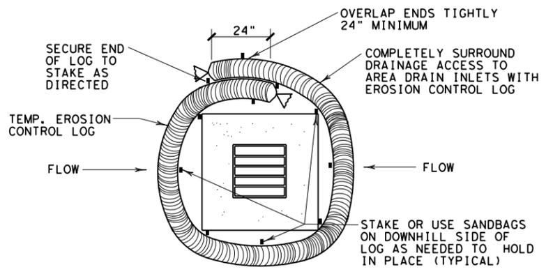
**EROSION CONTROL LOG AT DROP INLET**
