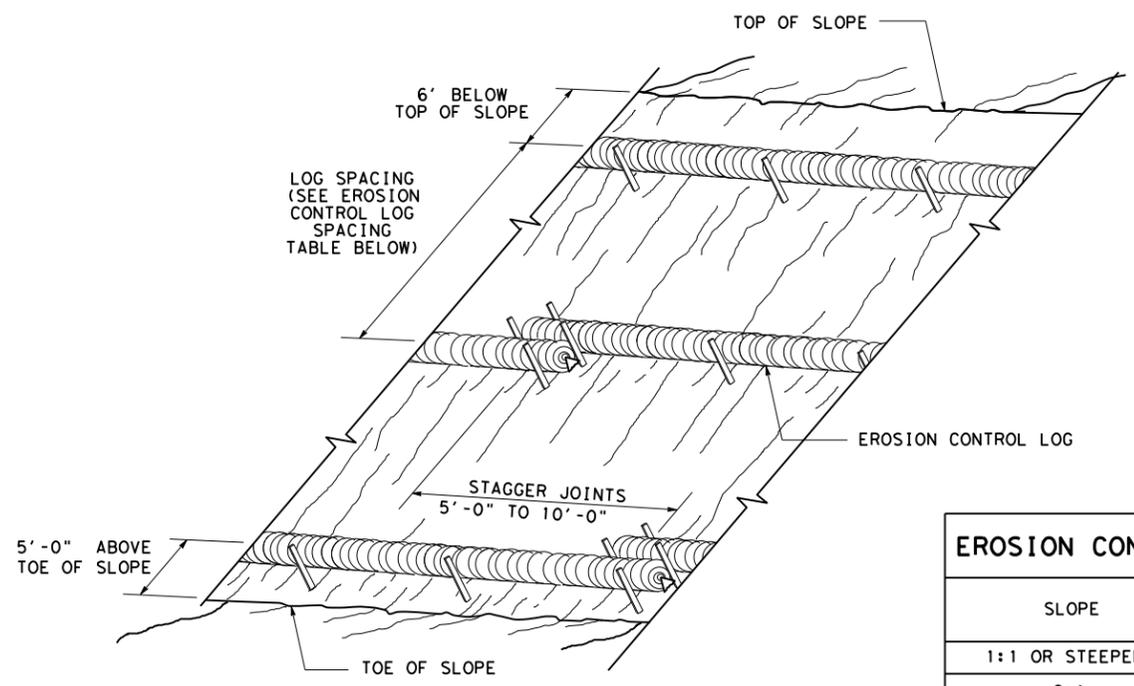
**EROSION CONTROL LOGS ON SLOPES
