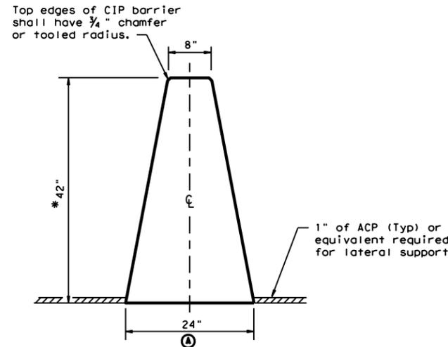
**SINGLE SLOPE CONCRETE BARRIER**
