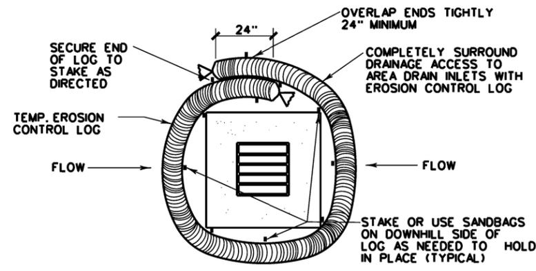
**EROSION CONTROL LOG AT DROP INLET**
