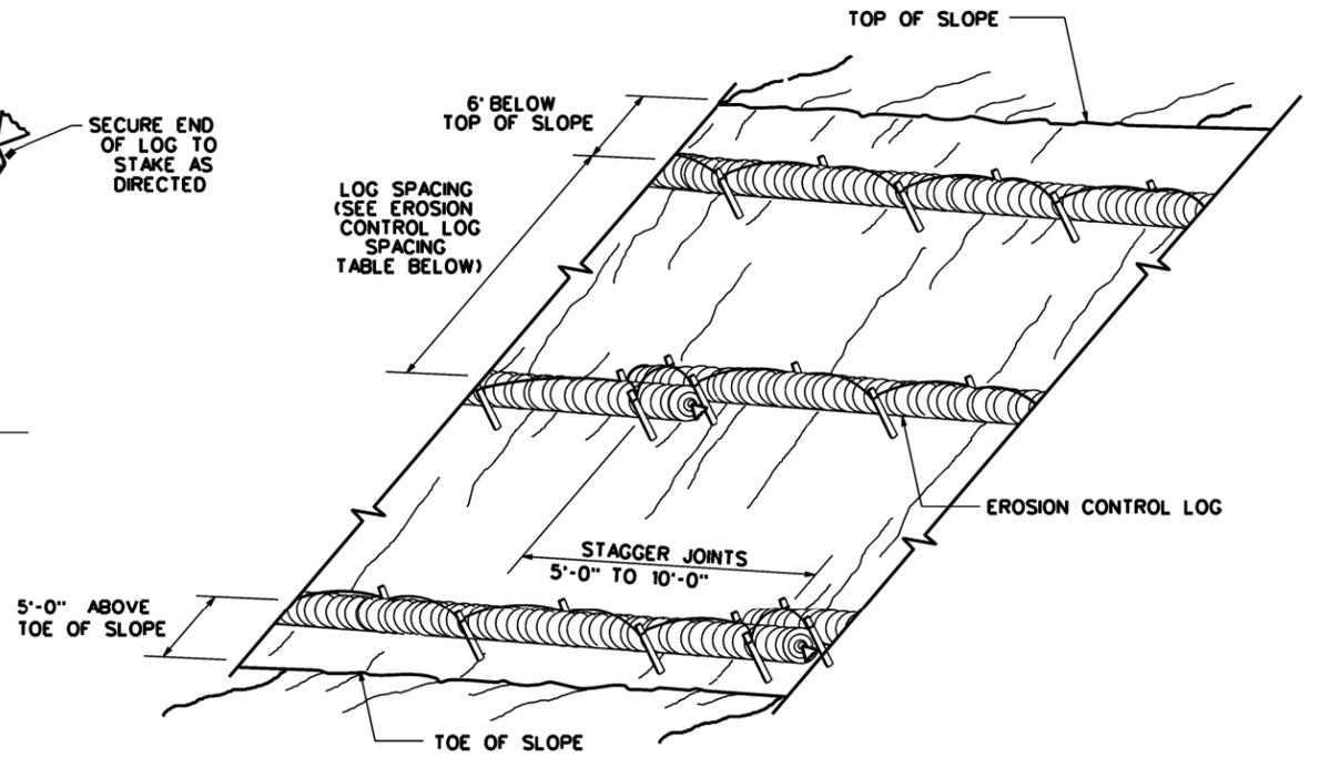
**EROSION CONTROL LOGS ON SLOPES
