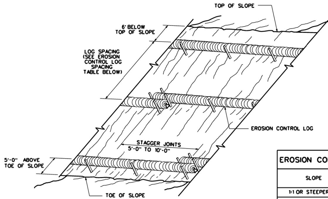
**EROSION CONTROL LOGS ON SLOPES
