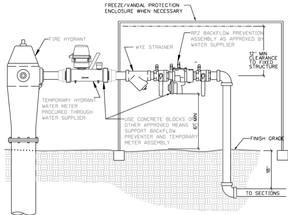
NOTE: TYPE OF BACKFLOW PREVENTER PER LOCAL CODE. LOCAL CODE SHALL HAVE PRECEDENT OVER THIS DETAIL.
