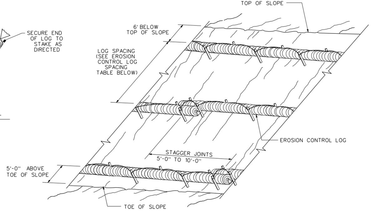
EROSION CONTROL LOGS ON SLOPES
