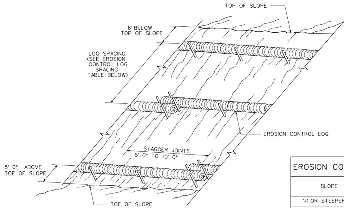
EROSION CONTROL LOGS ON SLOPES
