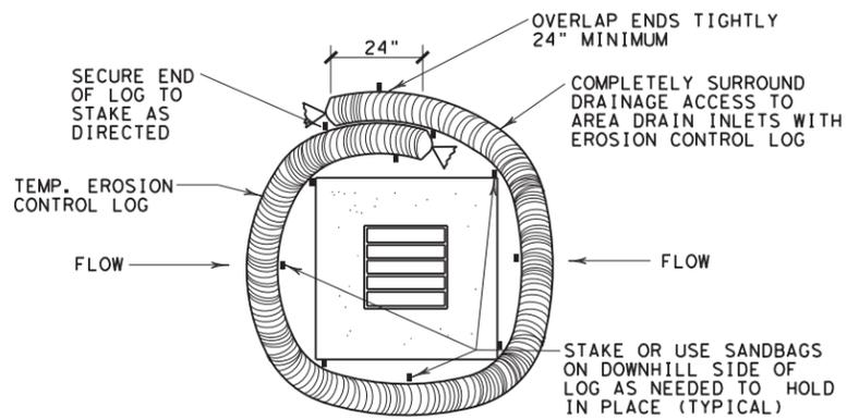
**EROSION CONTROL LOG AT DROP INLET**
