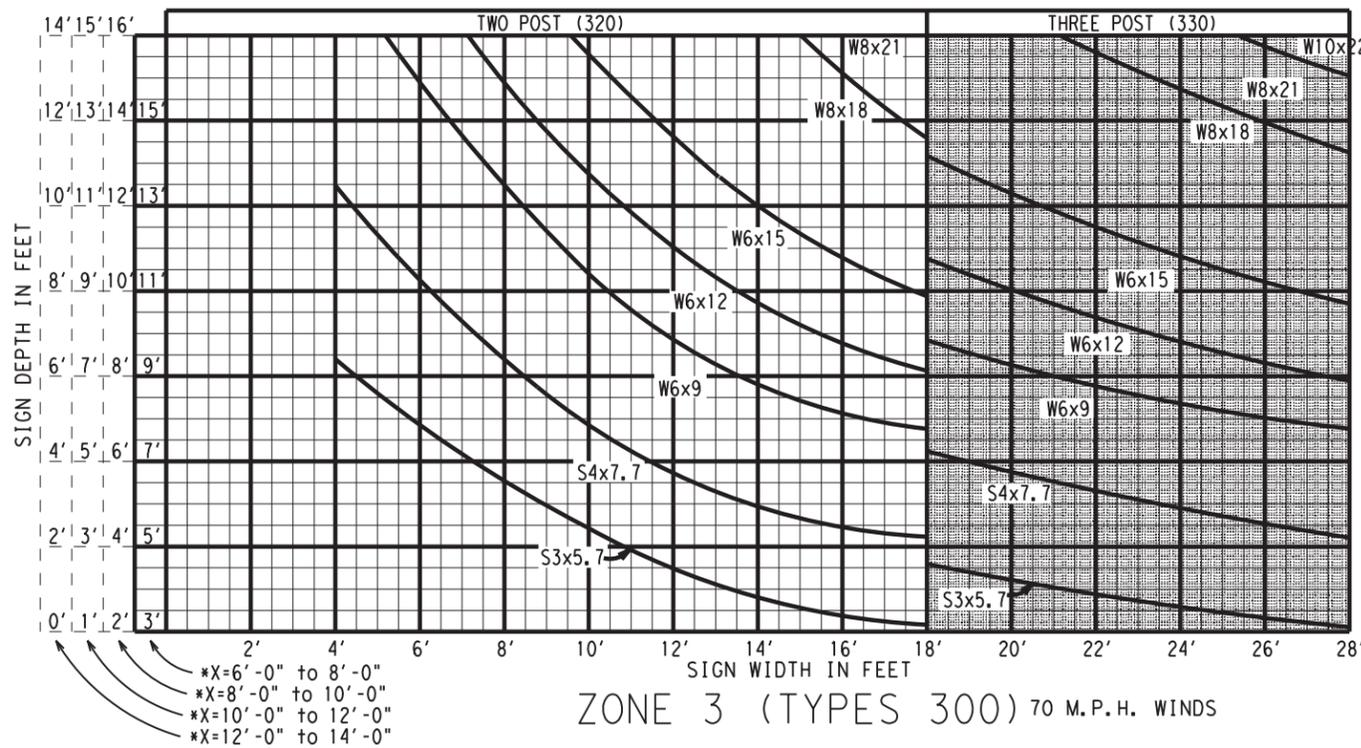
\* NOTE: "X" EQUALS THE AVERAGE HEIGHT FROM THE GROUND LINE TO THE BOTTOM EDGE OF THE SIGN.
