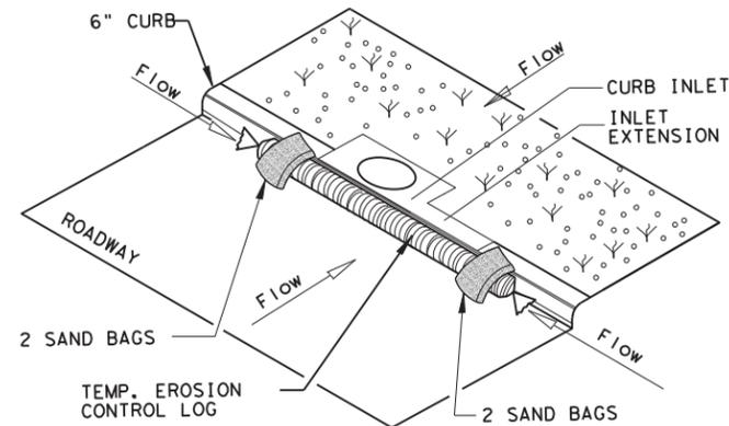
**EROSION CONTROL LOG AT CURB INLET**
