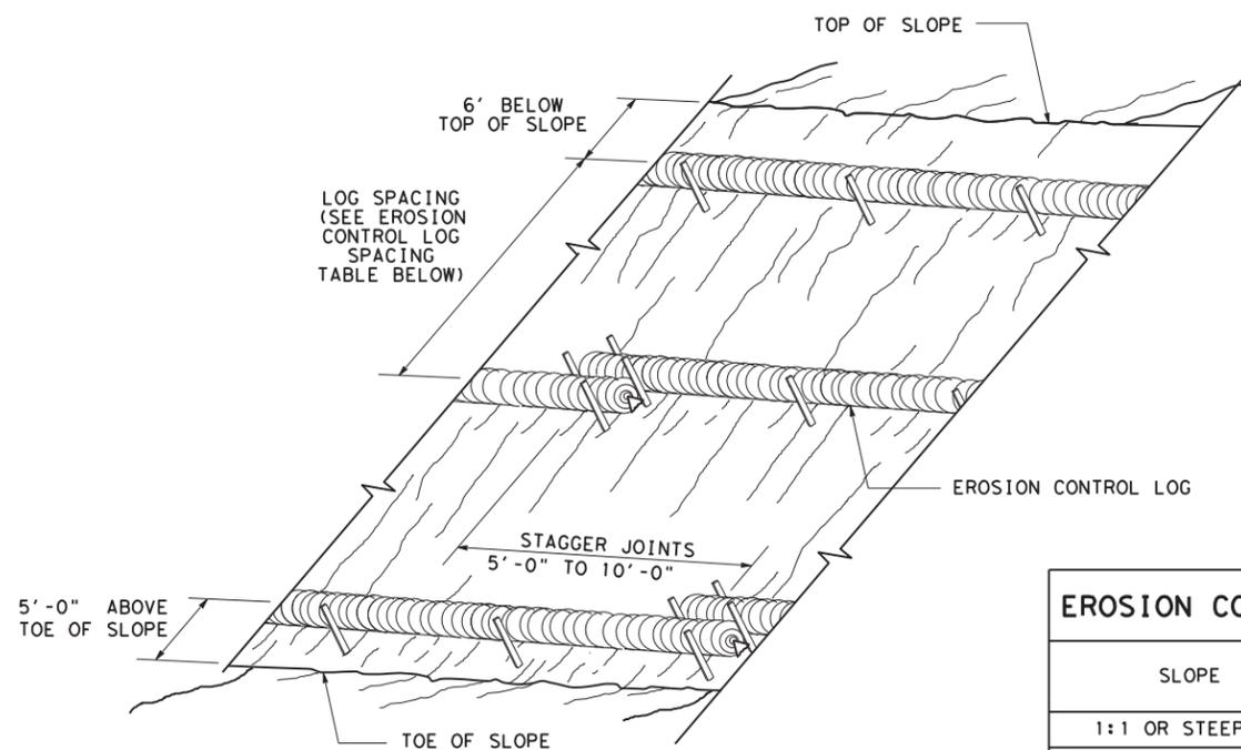
**EROSION CONTROL LOGS ON SLOPES
