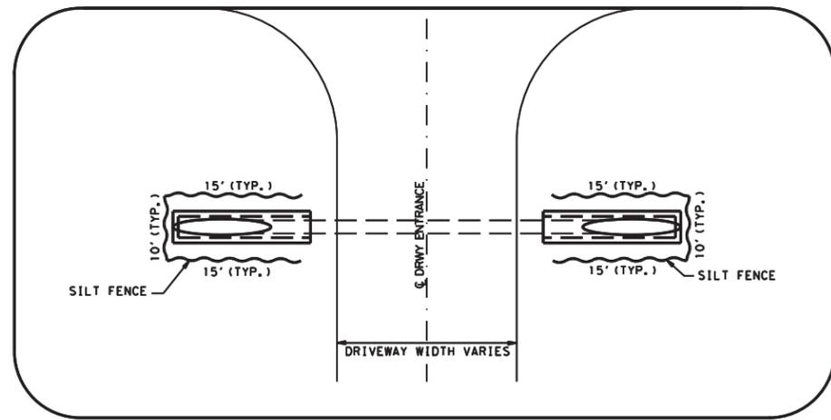
**5 SILT FENCE DETAIL FOR PIPE ON DRIVEWAYS**
