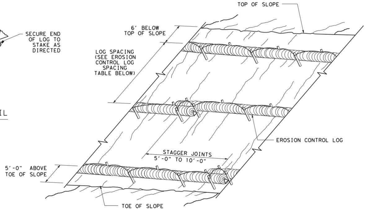
**EROSION CONTROL LOGS ON SLOPES
