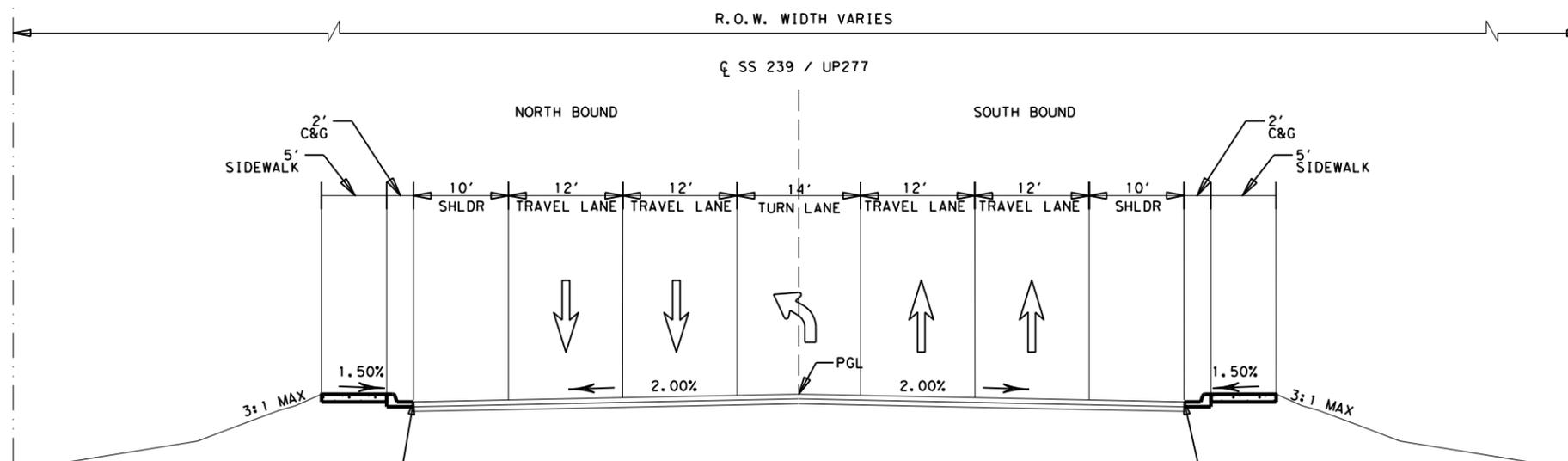
MATCH EXISTING ROADWAY CROSS SLOPE AND LONGITUDINAL SLOPE.
