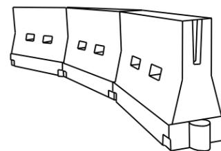
**LONGITUDINAL CHANNELIZING DEVICES (LCD)**
