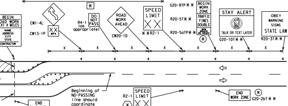
**SAMPLE LAYOUT OF SIGNING FOR WORK BEGINNING DOWNSTREAM OF THE CSJ LIMITS**
