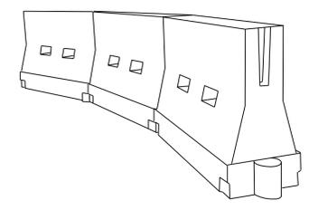
**LONGITUDINAL CHANNELIZING DEVICES (LCD)**
