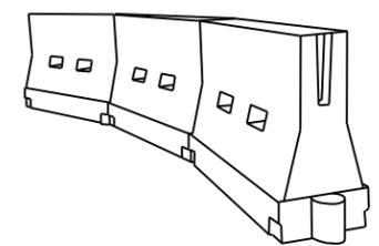
**LONGITUDINAL CHANNELIZING DEVICES (LCD)**
